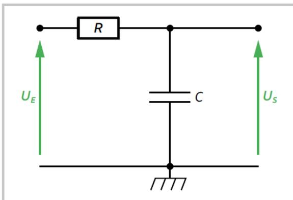
Filtre passe-bas intégré à la sortie du 1<sup>er</sup> étage du montage amplificateur (voir FT Amplifier un signal)
