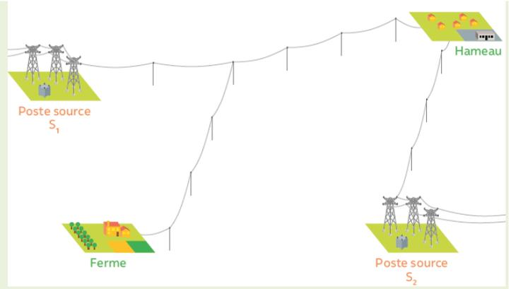
Un réseau de distribution électrique comprend deux postes source  $S_1$  et  $S_2$  distribuant respectivement des courants électriques d'intensité  $I_1$  et  $I_2$ . Un hameau est alimenté par ces deux postes source tandis qu'une ferme isolée est alimentée uniquement par le poste source  $S_1$ .
