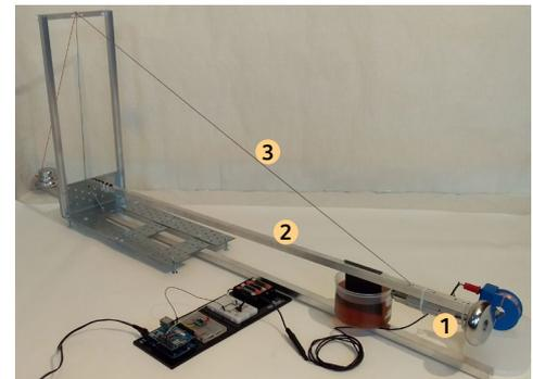
**Étape 2 :** Régler la position du bras oscillant, la période propre  $T_0$  du sismomètre et l'amortissement des oscillations.
