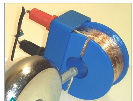
f. Photo d'un capteur électromagnétique réalisé avec une bobine de 70 \mu H et un aimant de type Géomag™
